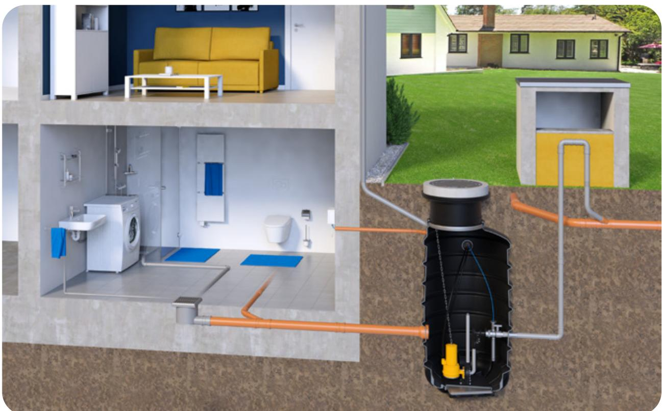
Abb.: FPS mit Schneidwerkpumpe ZFS 71
