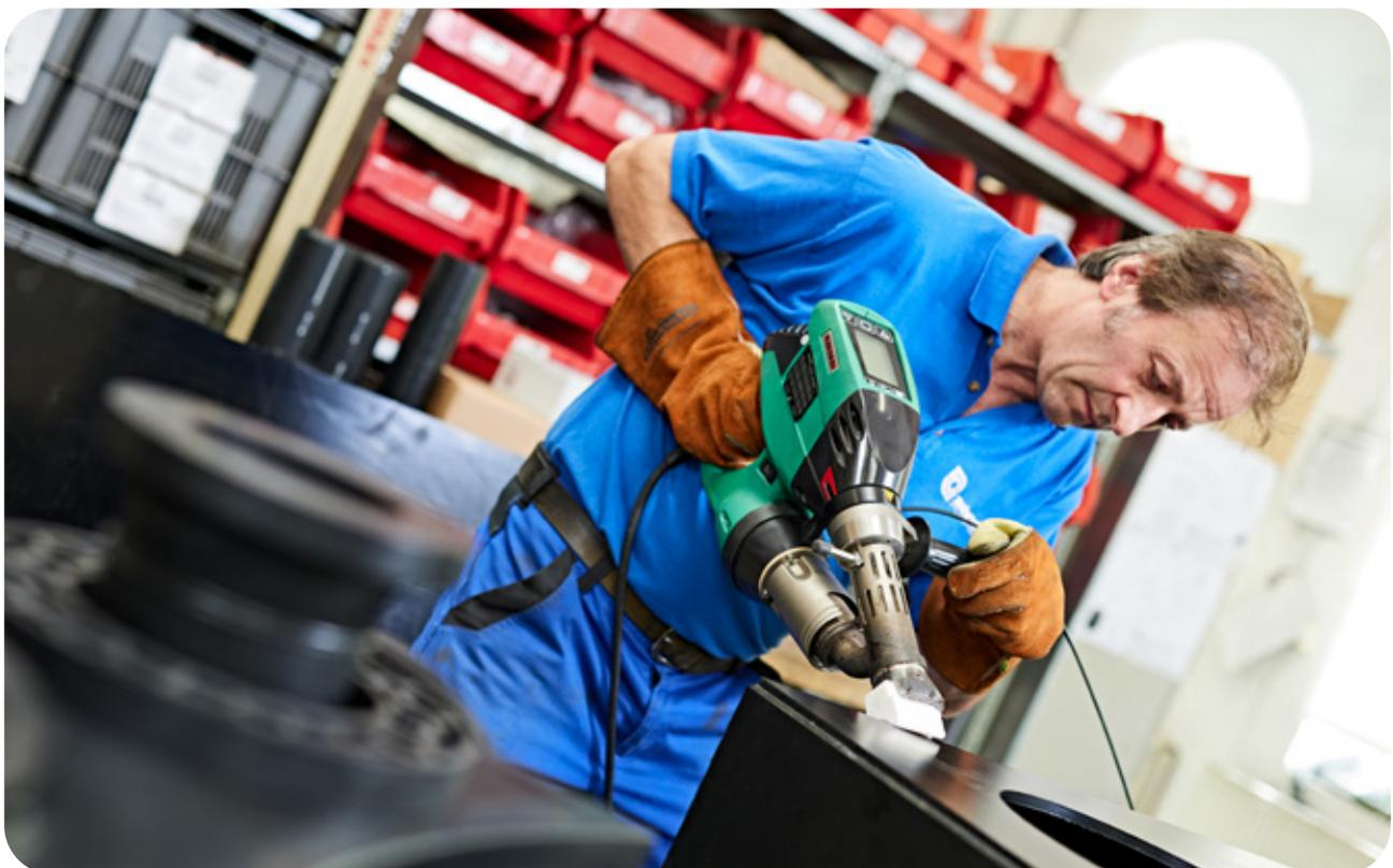
Abb.: Verschweißen von PE-Platten
